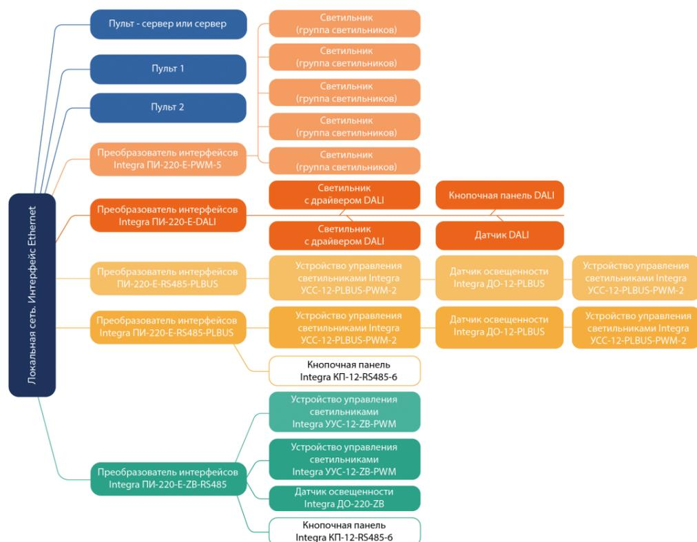
Рис 1. Структурная схема системы управления освещением.
